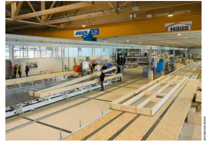
► Deckenelementfertigung in Falkenberg, rechts die Puffertische
